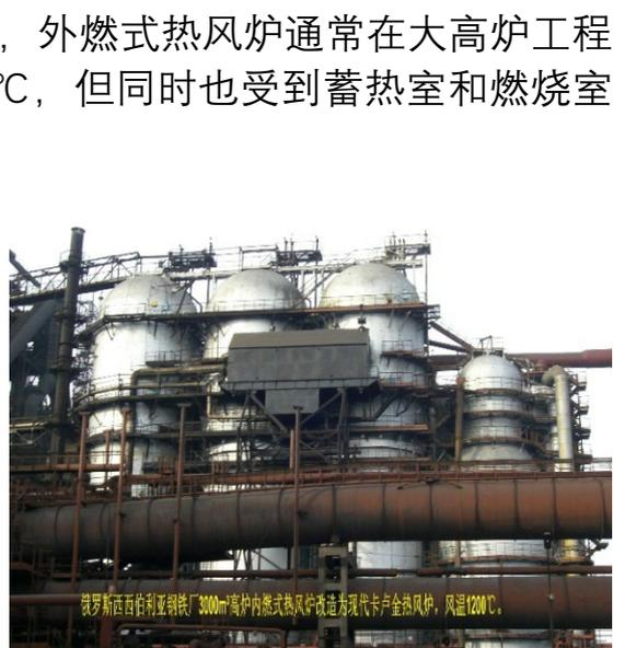
燃室、缩小顶燃式热风炉尺寸的研究一直在进行，直到 2000 年投产的利佩茨克钢铁公司 3 号高炉（3000m<sup>3</sup>）12#内燃式热风炉采用不停产方式改造的现代卡卢金热风炉投产，标志着现代卡卢金热风炉真正启动了内燃式热风炉改造工业实践。
