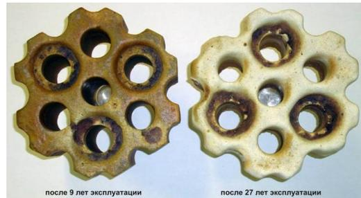
下塔吉尔顶燃式热风炉运行 9 年、27 年的硅质格子砖
