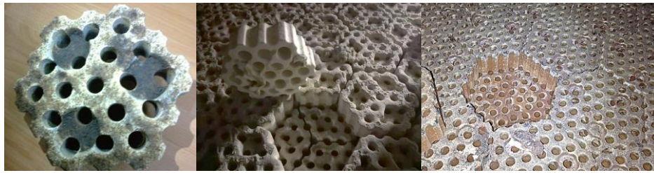
左、中图为卡卢金热风炉采用的 19 孔格子砖使用 12 年的情况， 右为 37 孔格子砖使用 10 年后情况
