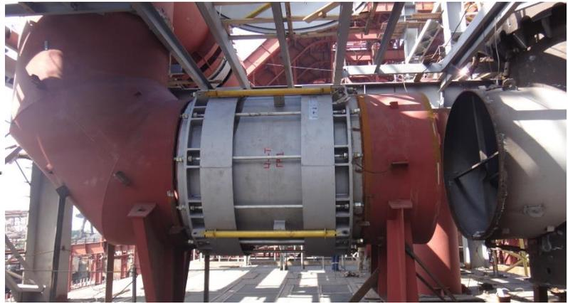
图 12 2000 年俄罗斯西西伯利亚钢铁公司 3000m<sup>3</sup> 高炉内燃式热风炉改造为卡卢金热风炉投产，采用“U”形热风支管（左），热风主管利用。2018 年俄罗斯下塔吉尔钢铁公司 2200m<sup>3</sup> 高炉卡卢金热风炉投产，采用“U”形热风支管，目前风温 > 1250℃（右）
